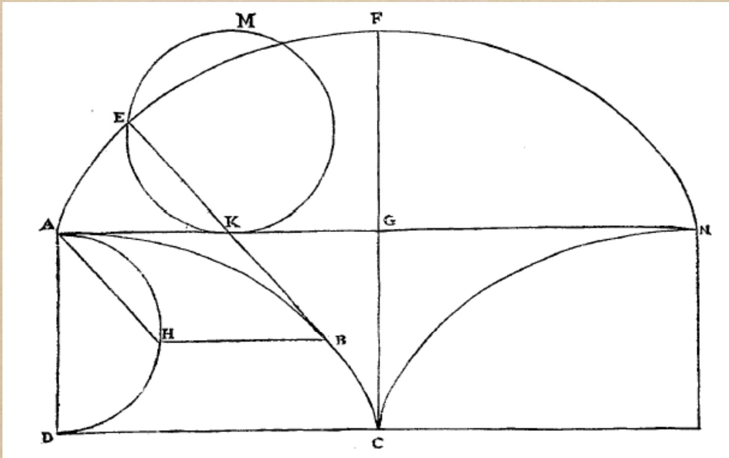
Per unicitat, acceptant que en desenvolupar les tangents són perpendiculars a la desenvolupada, la desenvolupada de la cicloide és la cicloide.
