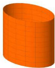
Cilindre el·líptic \left(\frac{x}{a}\right)^2 + \left(\frac{y}{b}\right)^2 = 1
