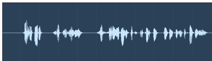
Figura 1.2: Senyal real corresponent a una veu dient "Hola pare, sóc l'Amèlia i em moro de ganes d'explicar-te tot el que m'ha passat avui". L'eix horitzontal representa el temps i el vertical l'amplitud del senyal.
