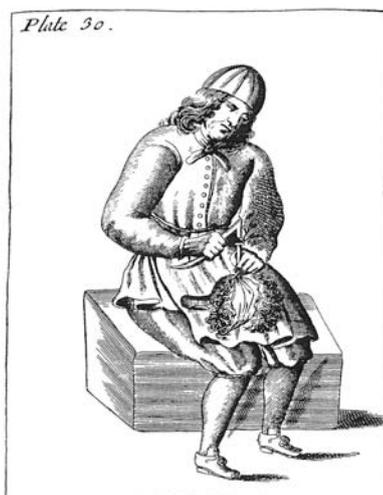
Fig. 77 Montado de una bala para entintar.
