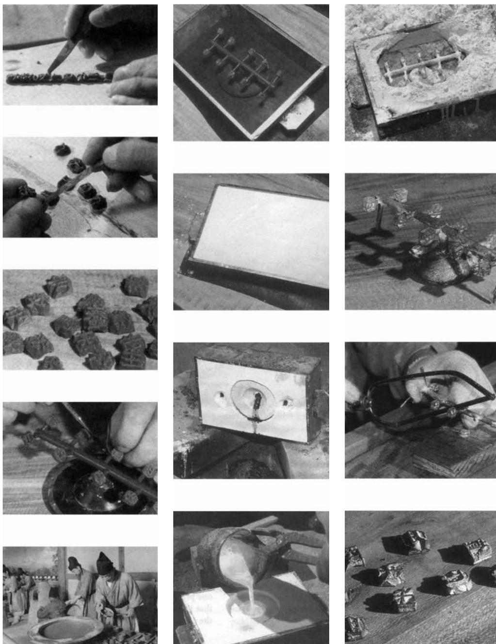
Fig. 24 Corte, fundido y arreglo.
